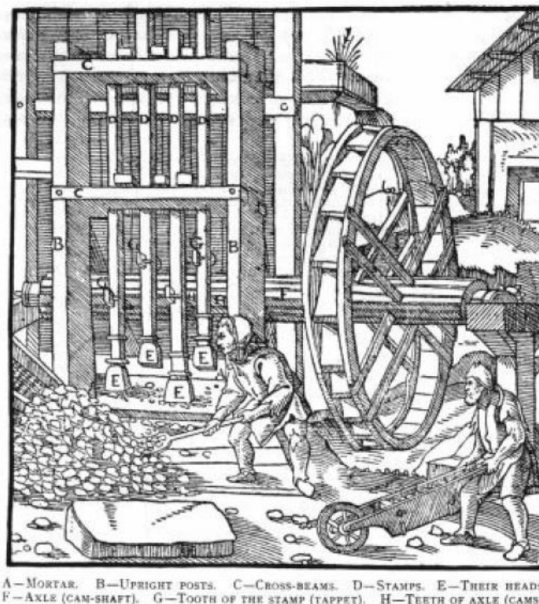
Figura 1.3. Moinho de trituração de pedra, movido a água (Adaptado de Vegt, 2007).
