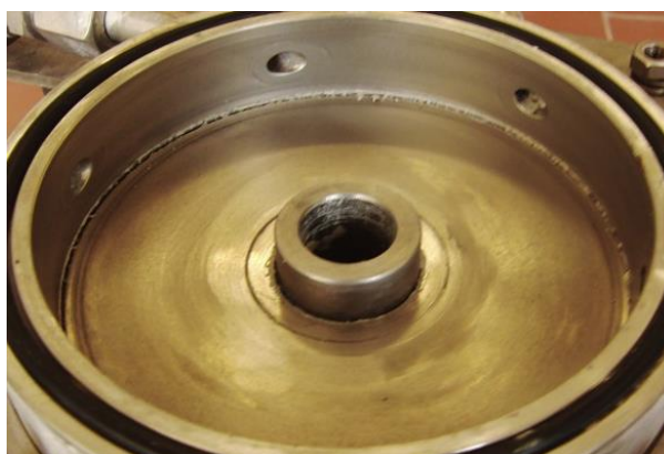
Figura 3.3. Tubo de exaustão inferior da câmara de micronização do jet mill utilizado na realização do trabalho.
