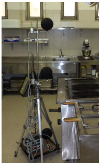
Figura 2.4. Exemplo de montagem do monitor e sensor de stress térmico
