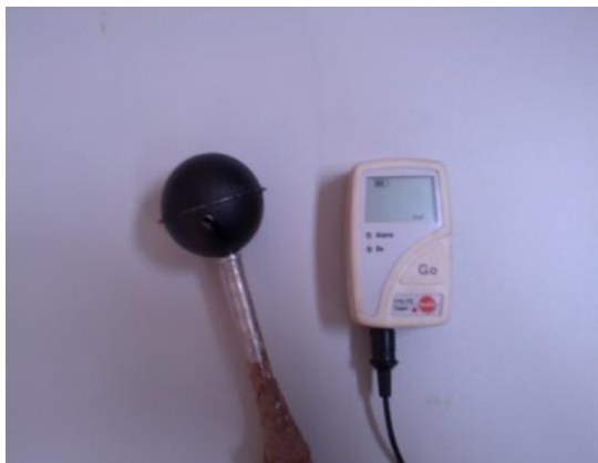
Figura 3.4. – Data Logger 175-T2 da Testo e globo negro de 50mm
