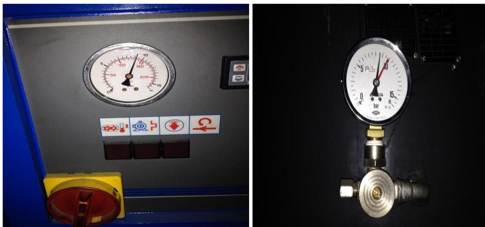
Figura 46 – Pressão no compressor (esquerda) e no reservatório (direita) logo após o fecho das torneiras
