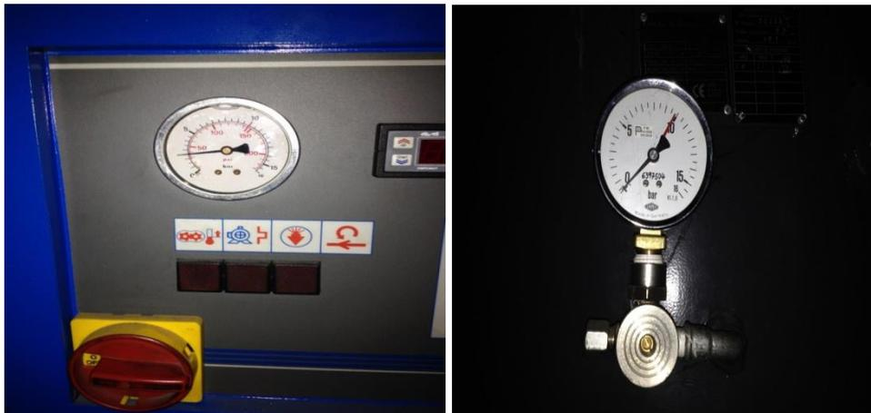
Figura 47 – Pressão no compressor (esquerda) e no reservatório (direita) na manhã seguinte
