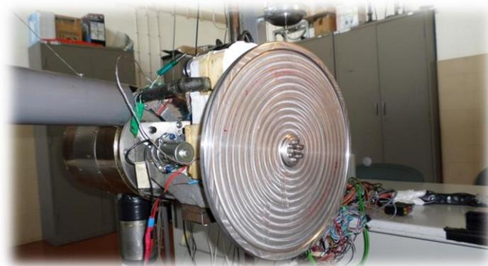
Figura 8 – Foto da roda de inércia utilizado no banco de ensaios.
