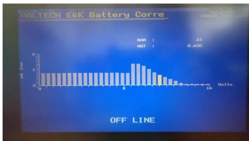
Figura 21 – *Battery Voltage Map* de correção do tempo de injeção.
