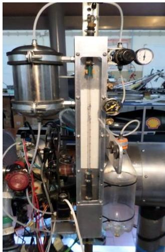
**Figura 27 – Foto do sistema de armazenamento e medição de combustível do banco de ensaios.**
