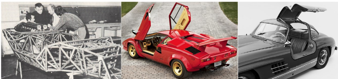
Figura 4 – Sentido esquerda-direita, chassi em gaiola Lamborghini Countach LP-400, portas tipo tesoura Lamborghini Countach 5000 quattrovalvole , portas tipo asa de gaivota Mercedes-Benz 300 SL Gullwing (Baron), (badass, 2013), (Hunter, 1999).
