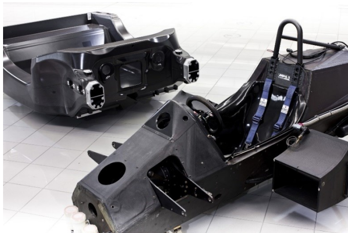
Figura 5 – Em primeiro plano, chassi monocoque McLaren MP4/1, em segundo plano habitáculo monocoque McLaren MP4-12C (Automotive).
