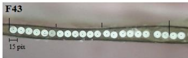
Figura 4-4. Fator de correção horizontal, obtido a partir da fotografia registada com recurso a um microscópio, das FO utilizada para medir a velocidade de detonação no ensaio 1 de caracterização do explosivo dador.
