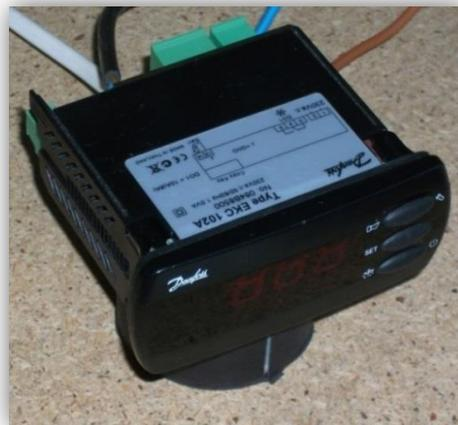
**Figura 3.5.** Controlador de Temperatura, EKC 102<sup>a</sup>.
