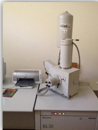
**Figura 3.14.** Microscópio electrónico de varrimento Philips XL30 TMP.
