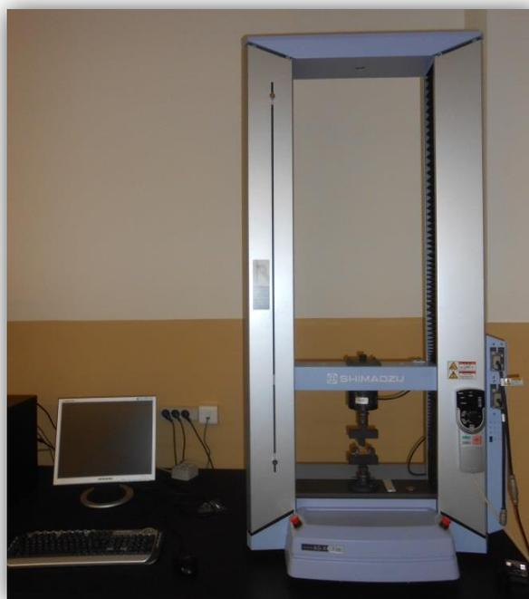
**Figura 3.3.** Máquina de Testes Universal Shimadzu Autograph AG-X.
