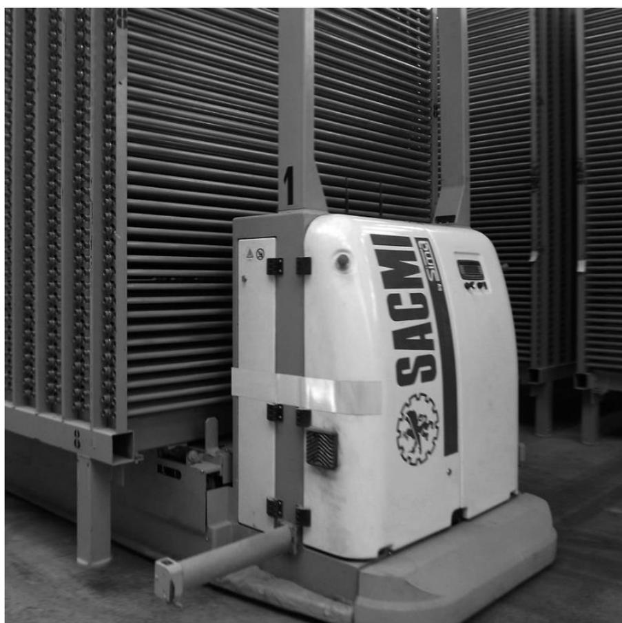
**Figura 4.5.** Movimentação de vagão por LGV (Fonte [38]).
