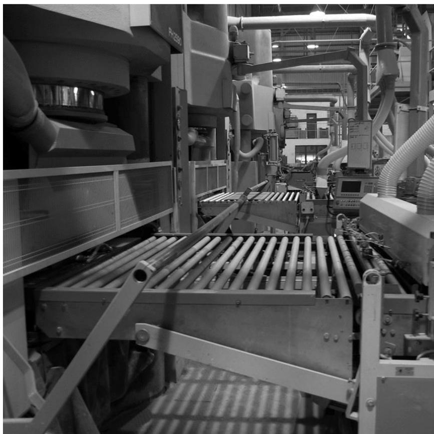
**Figura 4.4.** Rolos de saída das prensas, para os secadores (Fonte [38]).
