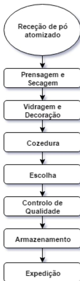
**Figura 4.8.** Diagrama do processo produtivo da Unidade 2 (Adaptado de [39]).
