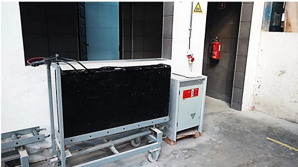
**Figura 4.12** Posto de carregamento de baterias dos LGV's da Unidade 1 (Fonte: autor).
