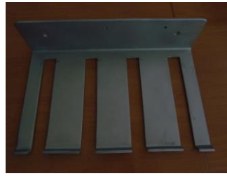
Figura 4.22-foto do suporte de mangueiras protótipo
