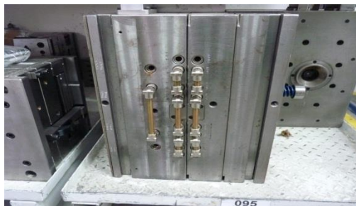
Figura 4.14 - Molde com ligações de água permanentes
