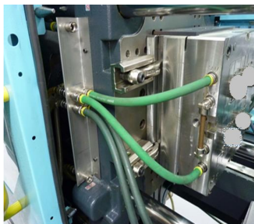
Figura 4.13 Ligação do molde à máquina
