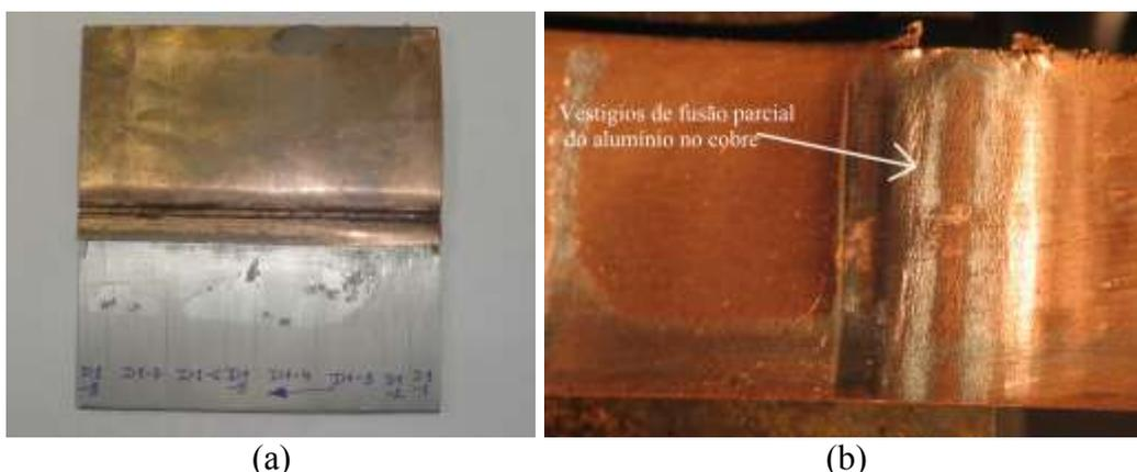
Figura 4.3: Soldadura EW1: (a) deformação da soldadura; (b) fusão parcial do alumínio no cobre.
