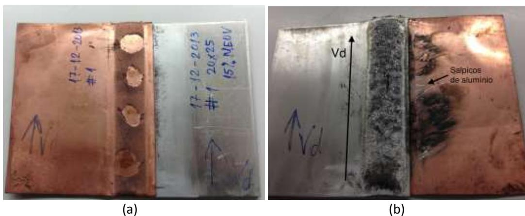
Figura 4.5: (a) Deformação superficial da soldadura EW5\_25; (b) salpicos de alumínio.
