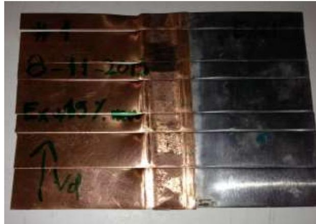
Figura 4.4: Deformação superficial da soldadura EW2.
