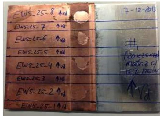
Figura 3.6: Corte e identificação das amostras.
