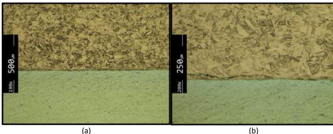
Figura 4.11: Morfologia da soldadura EW5\_25\_5: (a) ampliação de 100x; (b) ampliação de 200x.
