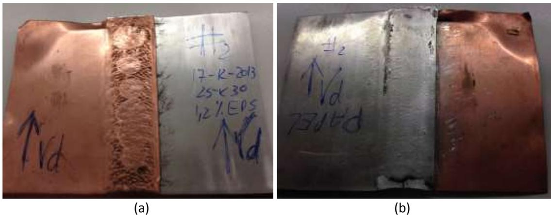
Figura 4.6: (a) Deformação superficial da soldadura EW6\_30; (b) morfologia da superfície de alumínio.
