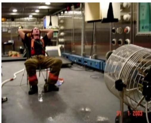
**Figura 1.1 - Técnica de arrefecimento corporal por convecção forçada de ar aplicada num bombeiro (adaptado de McLellan *et al.*, 2005).**
