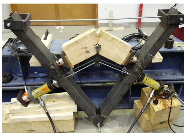
Figura 4-2 - Ensaio de uma ligação entre duas secções de madeira.
