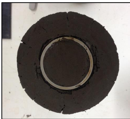
Figura 4.6 - Cravação do anel edométrico na amostra.
