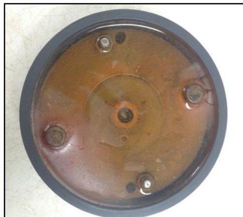
Figura 4.9- Aspeto da água presente na célula de consolidação no final do ensaio.
