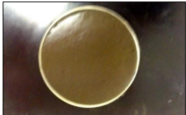
Figura 4.7- Amostra devidamente preparada para o ensaio edométrico.
