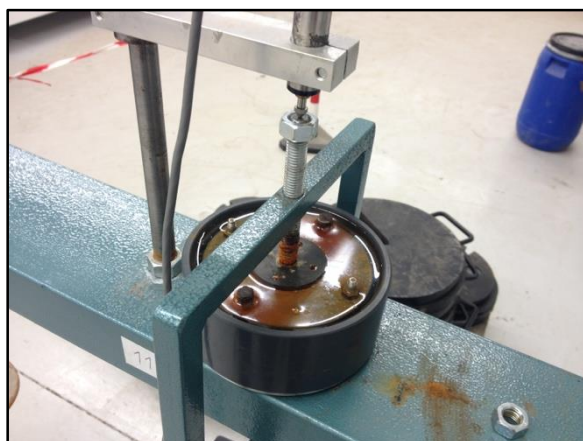
Figura 4.8 - Célula de consolidação preenchida por água (saturação da amostra).
