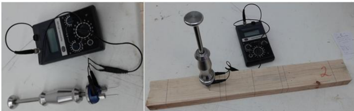
Figura 3.4 – Medição do teor de humidade, w (%) na madeira.
