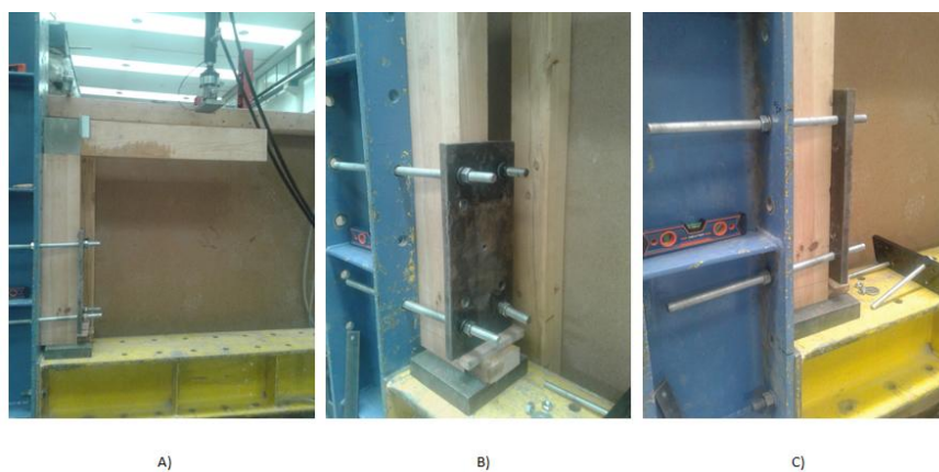
Figura 4.2 – Fixação do provete. A) Visão geral; B) e C) Visão amplificada.
