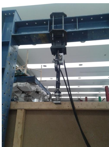
Figura 4.3 – Colocação do atuador rotulado em ambas extremidades.
