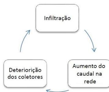
Figura 2.4 – Ciclo vicioso do trinómio infiltração/aumento dos caudais/deterioração (adaptado de Bonito (2014)).
