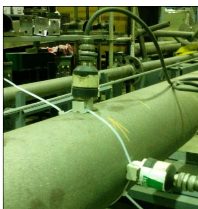
Figura 6.8 – Posicionamento dos acelerómetros na posição 3 – Acelerómetro vertical e horizontal
