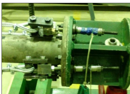
Figura 5.4 – Sistema de aplicação de carga nos cabos
