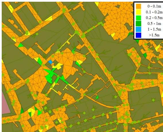
Figura 4.44 - Alturas de água verificadas após a implementação da Grelha 12.
