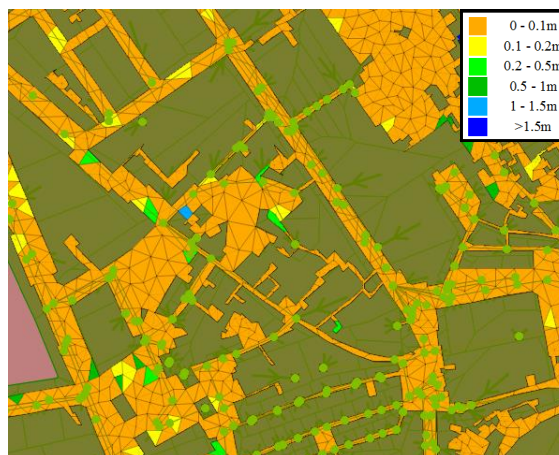
Figura 4.46 - Alturas de água verificadas após a implementação da Grelha 14.
