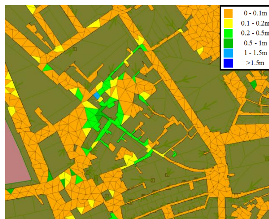
Figura 4.36 - Zona 2 em estudo após a implementação das 11 Grelhas a montante da Praça 8 de Maio.
