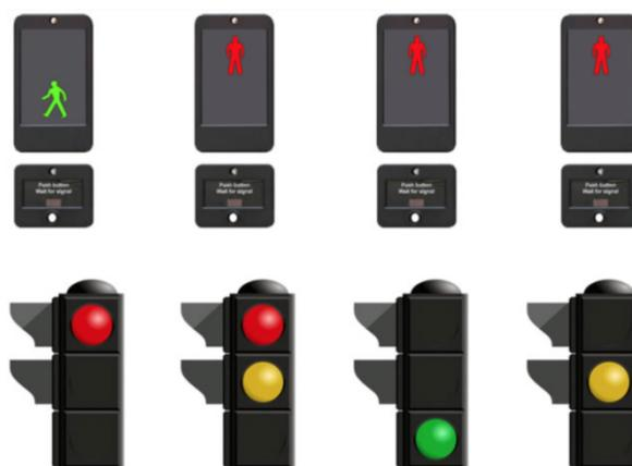
Figura 2.12 – Sequência de luzes para peões e condutores (Fonte: DTT@2015)
