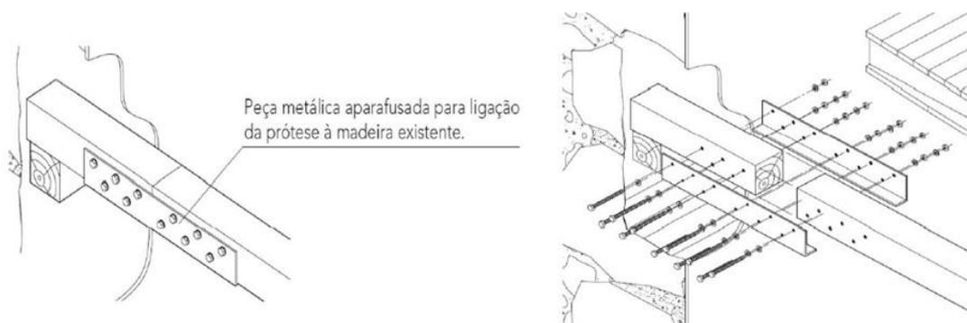
Figura 4.5 - Reforço de apoio com recurso a chapas “L” nas faces laterais conectadas mecanicamente
