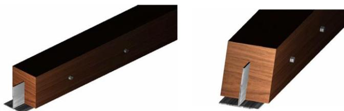
Figura 3.17 - Reforço de viga através da colocação de perfil "T" invertido na face inferior (França, 2007)
