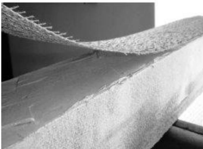
Figura 3.70 - Ensaio de viga reforça com fibras de aço de alta resistência coladas com resina epoxy (Corradi, 2011)
