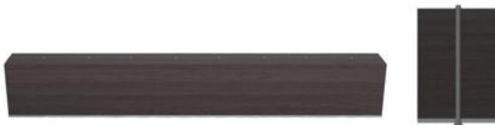
Figura 3.13 - Reforço através da colocação de chapa metálica na face inferior da secção, ligada por parafusos de porcas a toda a altura (Carneiro, 2012)
