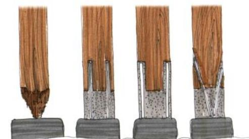
Figura 4.23 – Exemplos de reconstrução da base de pilar através de resina epoxídica com varões de reforço (Cunha, 2011)
