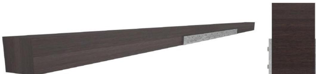
Figura 3.5- Reforço de viga através da colocação de chapas de aço colocadas lateralmente até metade da altura da viga existente (Carneiro, 2012)
