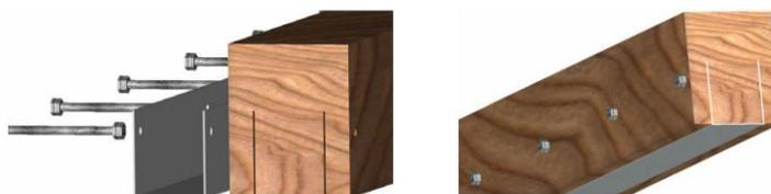
Figura 3.18 - Reforço de viga através da colocação de perfil "U" na face inferior (França, 2007)
