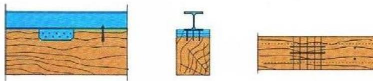
Figura 3.27 - Reforço de viga através da colocação de perfil IPE ou HEA na face superior e com chapa auxiliar, conectados mecanicamente com ligadores metálicos que perfuram apenas parte da viga
