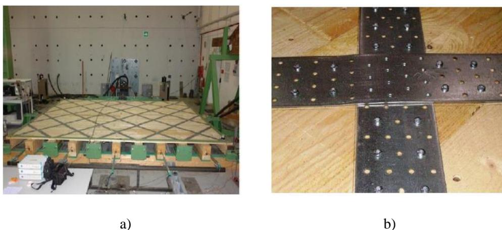
Figura 3.50 – a) Esquema de ensaio do reforço de pavimento; b) Pormenor da ligação (Baldessari, 2010)
