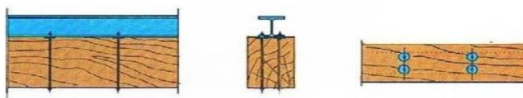
Figura 3.24 - Reforço de viga através da colocação de perfil IPE ou HEA na face superior, conectado mecanicamente com ligadores metálicos que percorrem toda a altura da secção de madeira (Mazzolani, 1991)
