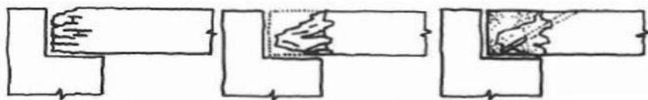
Figura 4.20 –Reforço com barras com remoção apenas da parte degradada (Arriaga, 2002)
