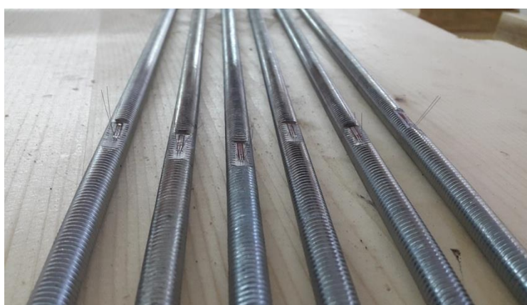
Fotografia 4.6 - Varões de aço com extensómetros aplicados
