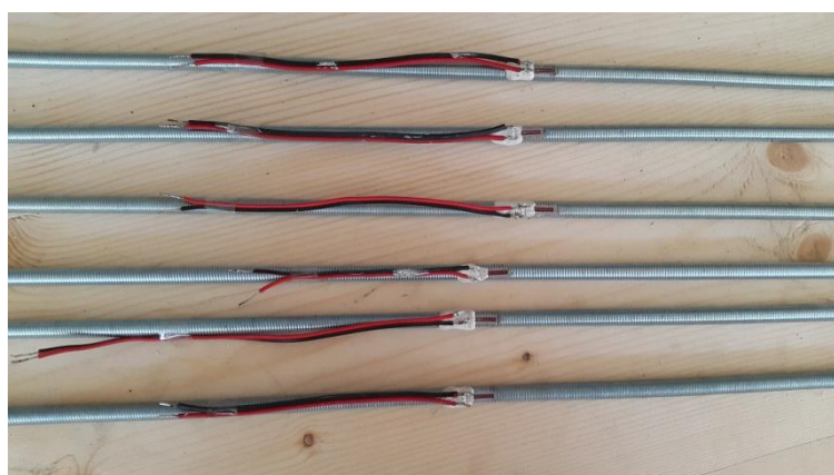
Fotografia 4.7 - Extensómetros soldados a cabos
