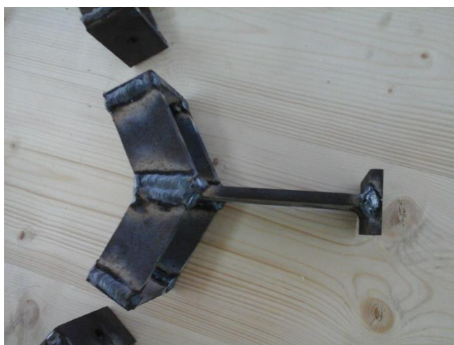
Fotografia 3.1 - Vista superior de um desviador
