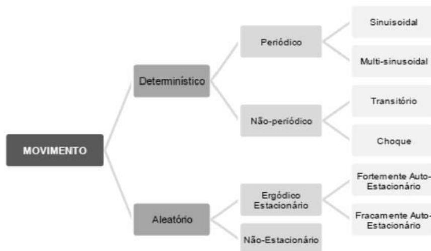
Figura 2.3 – Tipos de Vibração (adaptado de: Griffin, M. J, 1990)
