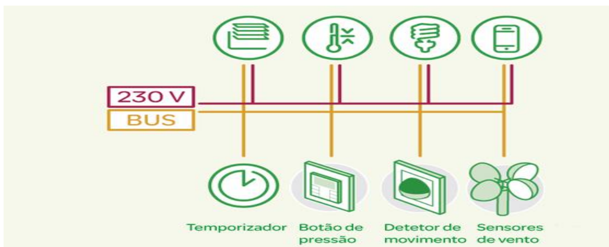
Figura 4.2 Sistema bus de dois fios, Twisted Pair , acompanhando em paralelo a rede elétrica de 230 V (Fonte: Schneider Electric®, 2015).
