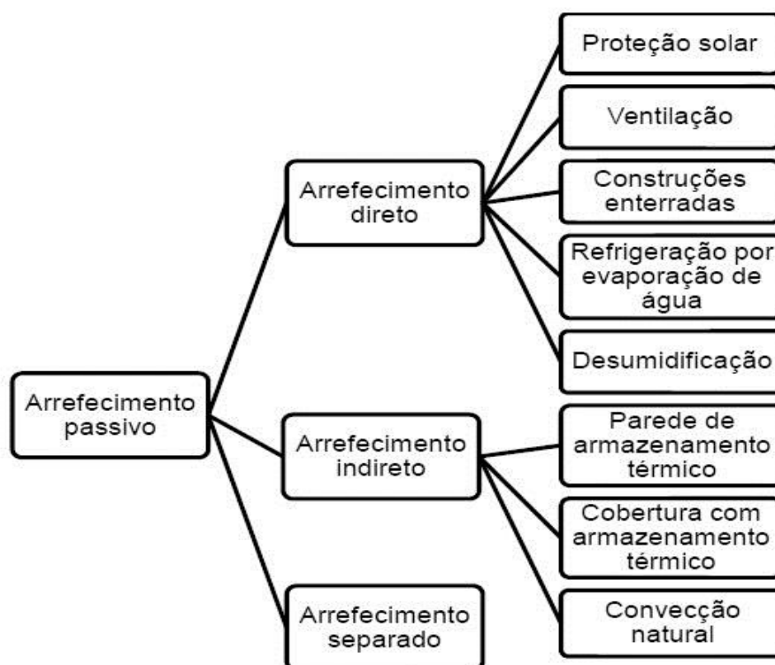
Figura 2.10 Esquema com os tipos de sistemas de arrefecimento passivo (Fonte: Soares, 2013).
