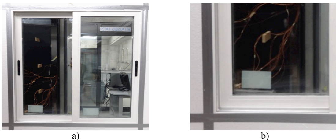
Figura 4.2.2 – Janela utilizada em ensaio realizado na Hot-Box: a) Vista geral do provete; b) Pormenor da superfície do caixilho da janela.
