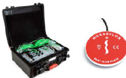
Figura 2.5.1 – Termofluxímetro: sensores de fluxo e termopares.
