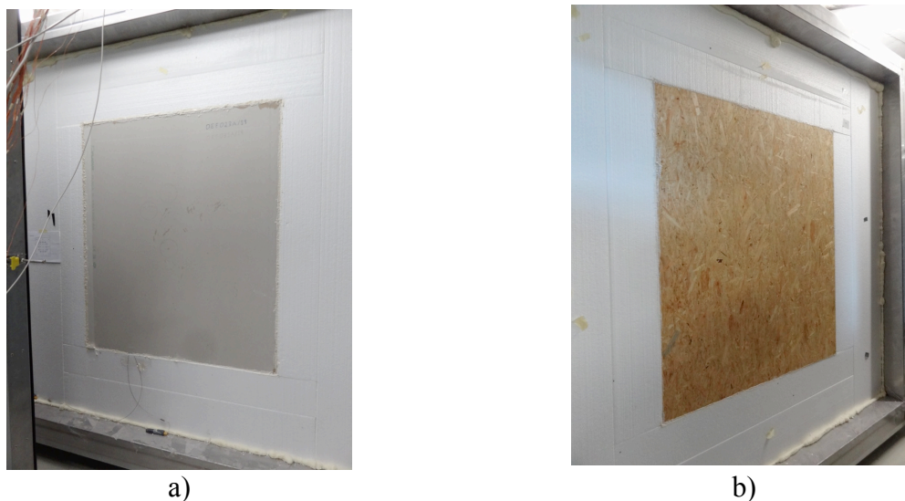
Figura 4.2.6 – Preparação da parede para medições na Hot-box - a) Vista da superfície de gesso cartonado; b) Vista da superfície de OSB.
