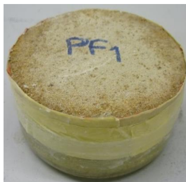
Figura 3.15 – Conjunto provete/tina para ensaio de permeabilidade ao vapor de água
