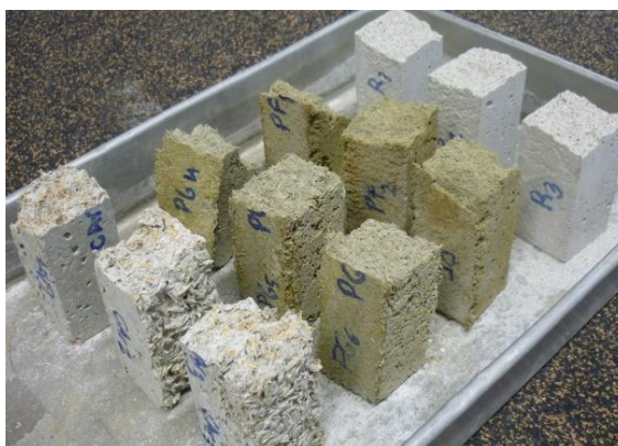
Figura 3.9 – Metades resultantes do ensaio de resistência à tração por flexão
