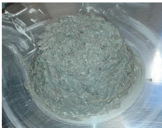
Figura 4.2 – Ensaio de consistência por espalhamento de ACA
