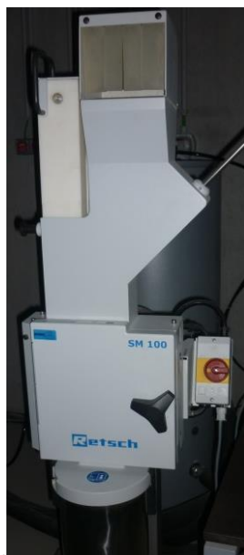
Figura 3.2 – Moinho utilizado para triturar a palha de arroz
