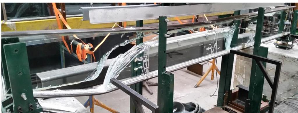
Figura 4.61 – Representação da viga híbrida após a sua rotura (Viga 2).
