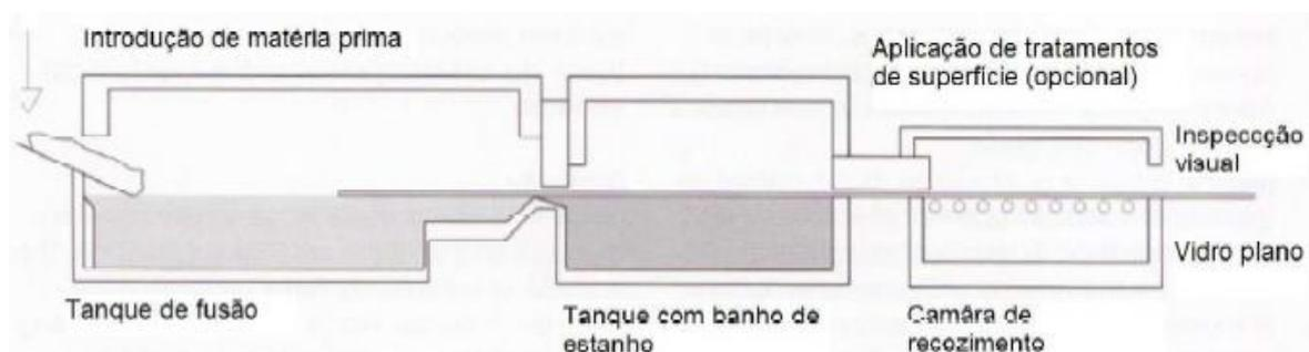
Figura 3.2 – Esquema do “processo de flutuação” de Alastair Pilkington para o fabrico de vidro (Valarinho, 2010).
