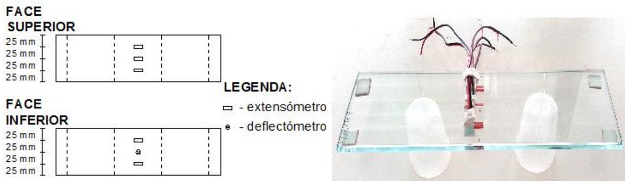
Figura 4.15 - Representação esquemática da instrumentação e provete instrumentado (Jordão, 2013).
