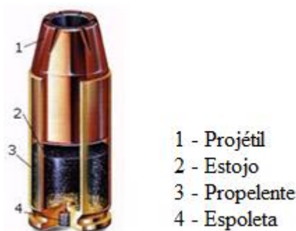
Figura 2.14 – Representação esquemática de uma munição (sindespe, 2015).
