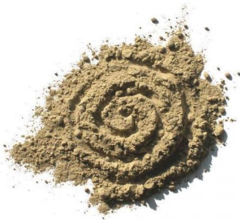
Figura 4.12 – Bentonite sódica utilizada nas SFMs (AMCOL®, 2014).
