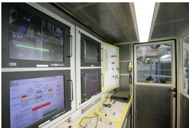
Figura 2.15 – Sala de comandos de uma Single Shield TBM (Metrostav a.s.@, 2014).
