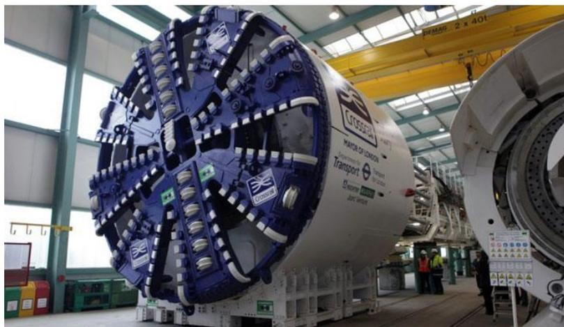
Figura 4.13 – “Mary”, a SFM contruída para a escavação do Túnel “Water Lee” sob o rio Tamisa para o projecto “Crossrail”, Londres, Reino Unido (TunnelTalk@ 2013).
