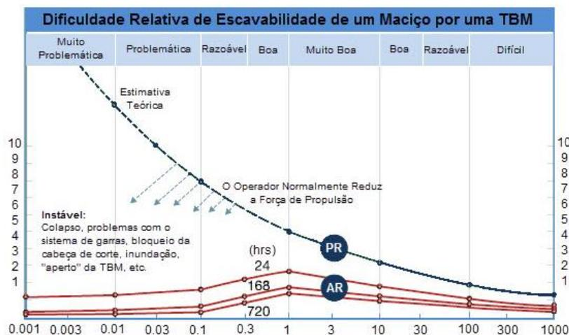
Figura 5.3 – Aplicação do  $Q_{TBM}$  (adaptado de Barton, 2003).
