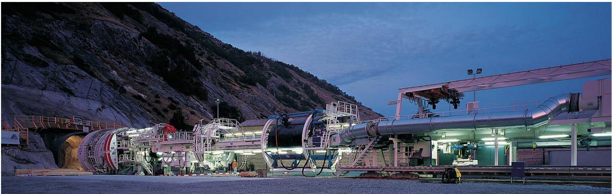
Figura 2.13 – Gripper TBM e parte do sistema de backup construídos para abertura do Túnel Ferroviário Base de Lötschberg, Suíça, 2003 (Herrenknecht AG@, 2013).
