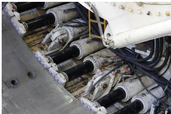
Figura 4.7 – Macacos hidráulicos de uma EPBM a actuar no suporte final do túnel (evergreenline@, 2014).
