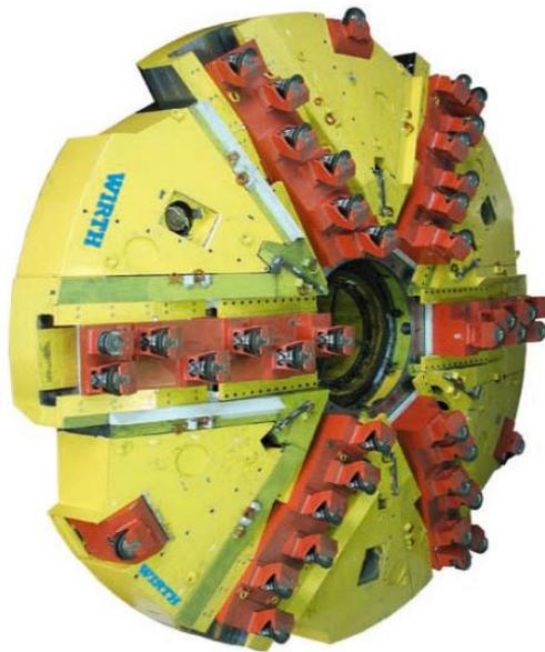
Figura 3.10 – Cabeça de corte com tecnologia de “*Undercutting*” (Aker Wirth®, 2005).
