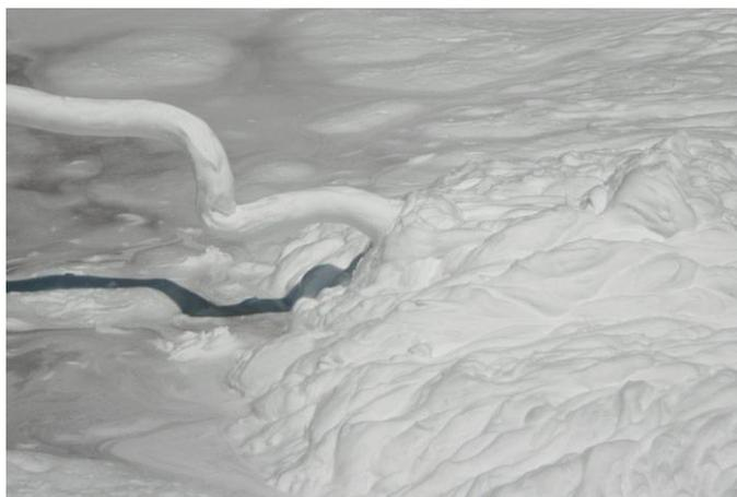
Figura 4.5 – Solução de água e espumas utilizada numa EPBM (TunnelTalk@ 2009).
