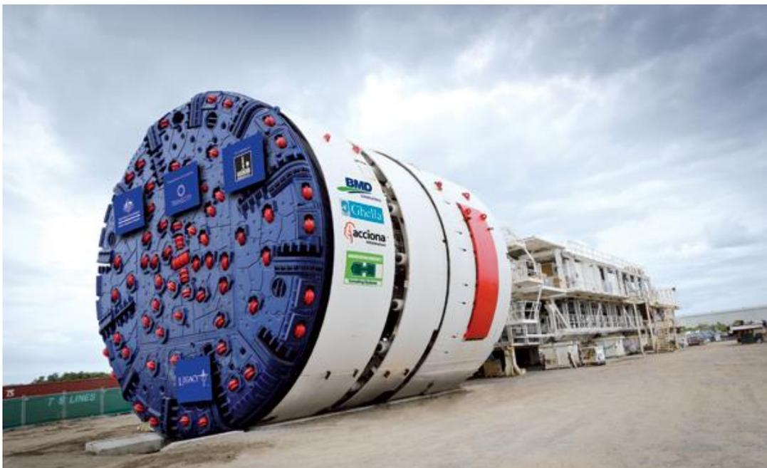
Figura 3.15 – Uma de duas *Double Shield* TBM construídas pela Herrenknecht AG para a escavação dos túneis gémeos “Legacy Way”, Brisbane, Austrália (Transcity@, 2014).
