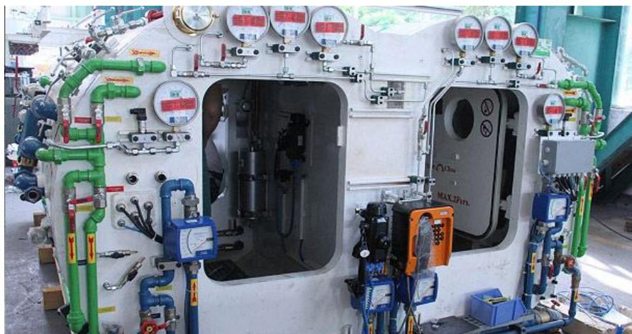
Figura 4.9 – Câmara hiperbárica tipo a instalar numa tuneladora (2014, TunnelTalk.com).
