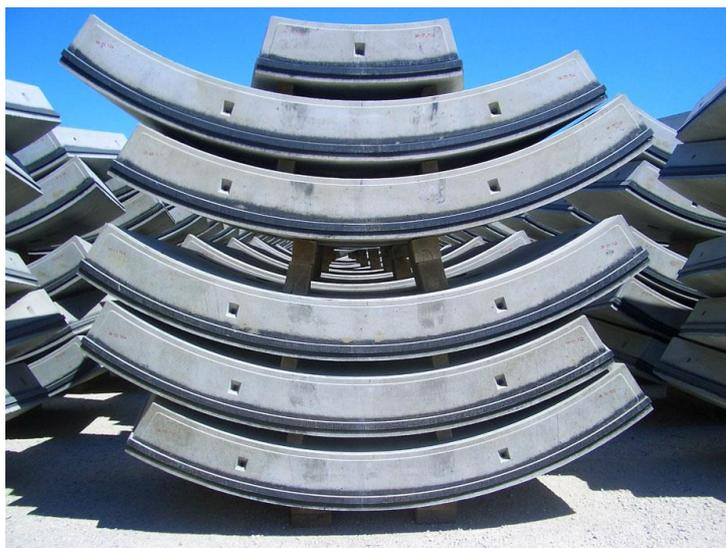
Figura 2.8 – Conjunto de seis segmentos que perfazem um anel de suporte final (TunnelTalk@, 2007).
