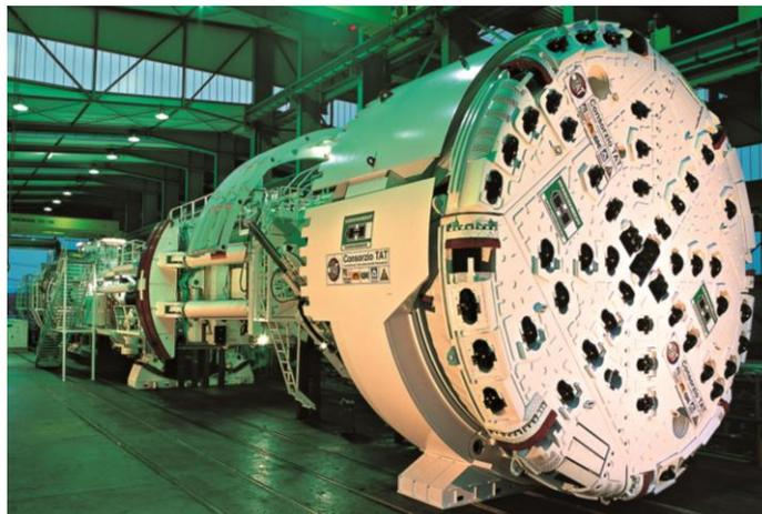
Figura 3.2 – Gripper TBM do túnel ferroviário base de São Gotardo, Alpes Suíços (Herrenknecht AG@, 2014).
