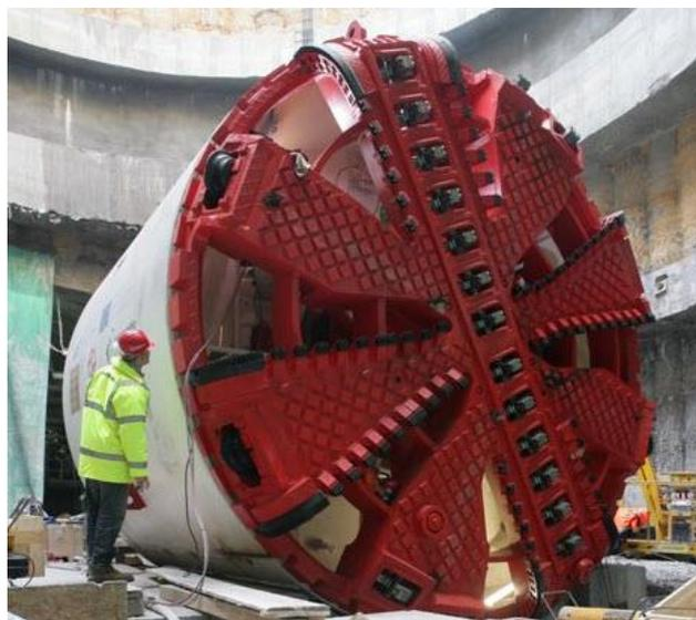
Figura 3.14 – Cabeça de corte para um maciço alterado de uma Single Shield TBM (Metrostav a.s.@, 2014).
