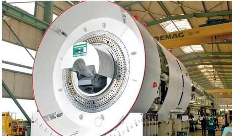
Figura 3.17 – Escudos e rolamento de uma *Double Shield* TBM construída para a escavação do túnel hidráulico de 18 Km da Barragem de Srisailam, Índia, 2008 (Herrenknecht AG).
