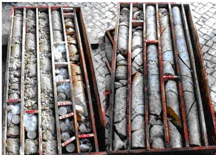
Figura 6.2 – Testemunhos obtidos de uma prospeção nos Granitos do Porto (Matos, 2006).
