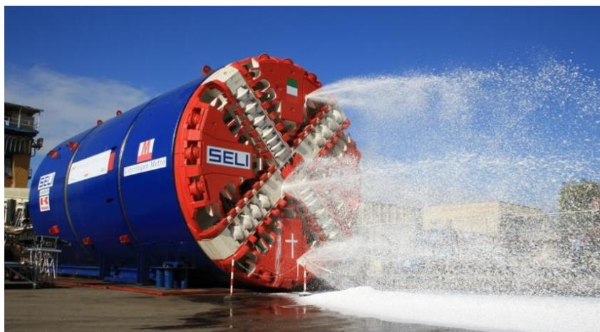
Figura 4.2 – Teste de funcionamento da tuneladora construída pela Seli-Kawasaki para o metro de Copenhaga (Tunneltalk@, 2012).
