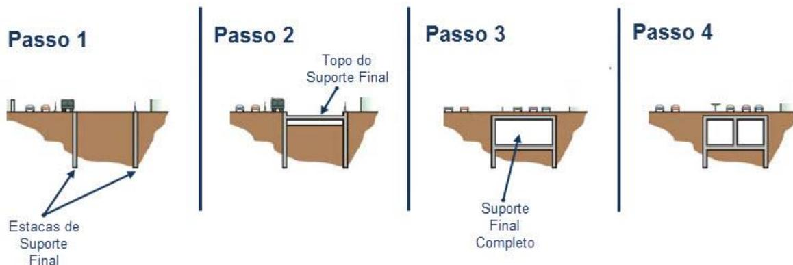
Figura 2.2 – Sequência da construção de cima para baixo a céu aberto (adaptado de FHWA, 2009).
