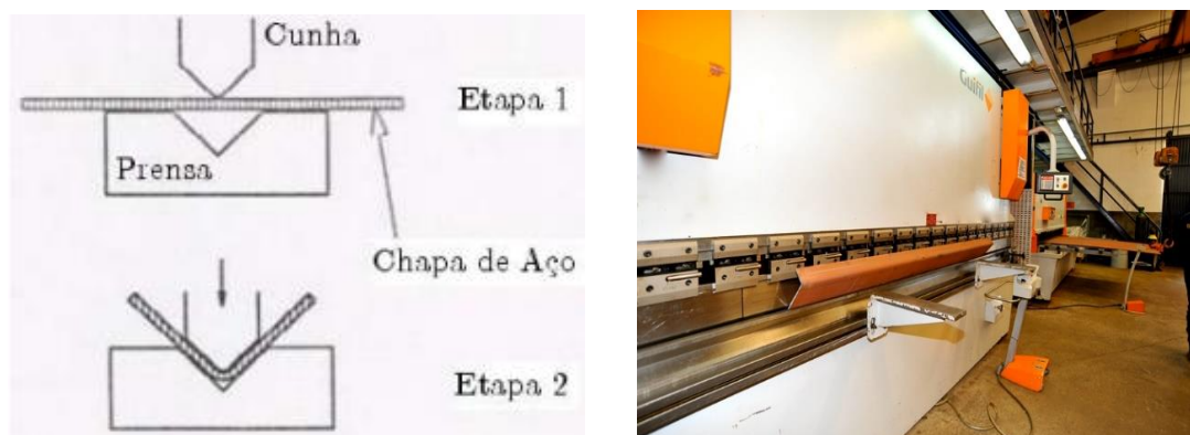
Figura 2.6 – Exemplo do processo de quinagem: (a) processo de quinagem [8] e (b) exemplo de uma máquina quinadora [13]
