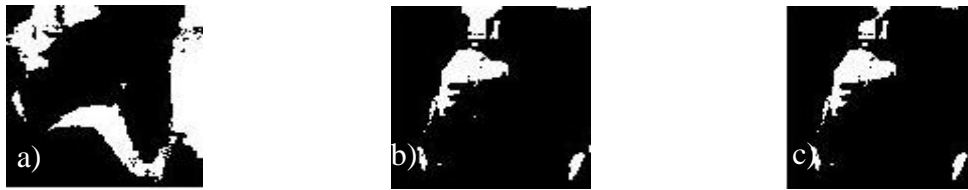
Figura 4.19 - Segmento ( 100 \times 100 ) com maior desaparecimento para a cor vermelha na estrutura em talude para uma altura de onda de 4.0 m; a) Imagem Inicial; b) Imagem Final; c) Subtração entre as duas imagens.
