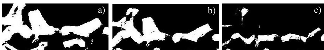
Figura 4.7 – Segmento (132×200) com maior desaparecimento para a cor vermelha na estrutura em talude para uma altura de onda de 3.5 m; a) Imagem Inicial; b) Imagem Final; c) Subtração entre as duas imagens.
