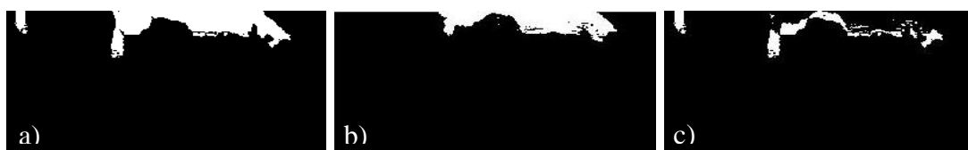
Figura 4.6 – Segmento (132×200) com maior aparecimento para a cor vermelha na estrutura em talude para uma altura de onda de 3.5 m; a) Imagem Inicial; b) Imagem Final; c) Subtração entre as duas imagens.
