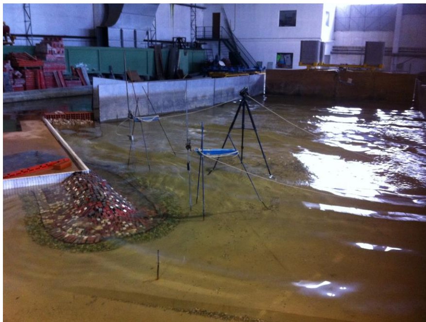
Figura 3. 6 - Posicionamento das sondas no modelo reduzido tridimensional
