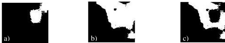
Figura 4.32 – Segmento (100×100) com maior aparecimento para a cor verde na estrutura em talude para uma altura de onda de 4.5 m; a) Imagem Inicial; b) Imagem Final; c) Subtração entre as duas imagens.
