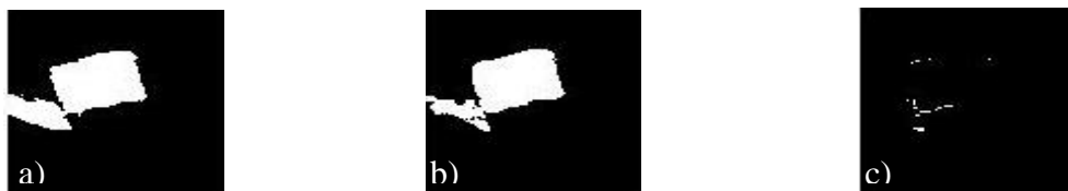
Figura 4.50 – Maior movimento obtido por desaparecimento para os cubos no modelo tridimensional com altura de onda de 4.5 m; a) Imagem Inicial; b) Imagem Final; c) Subtração entre imagens
