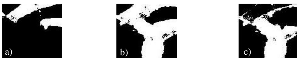
Figura 4.29 - Segmento (100×100) com maior aparecimento para a cor vermelha na estrutura em talude para uma altura de onda de 4.5 m; a) Imagem Inicial; b) Imagem Final; c) Subtração entre as duas imagens.
