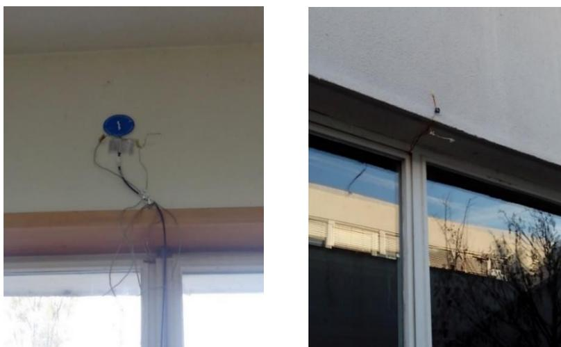
Figura 4.13 – Termofluxímetro e sensores de temperatura na solução 2
