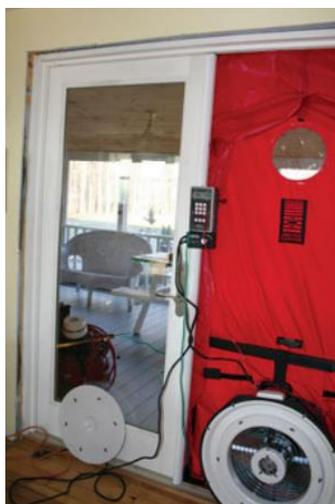
Figura 2.10 – Técnica de ventilação pressurizada (Keefe, 2010)
