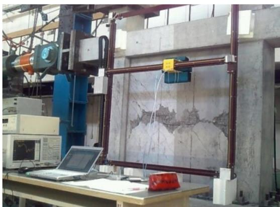
Figura 2.14 – Método da deteção por radar (Sato et al., 2014)
