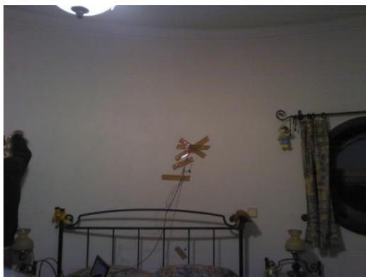
Figura 4.21 – Termofluxímetro e sensor de temperatura no pilar
