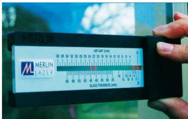
Figura 2.11 – Equipamento para identificação da espessura dos vidros e da caixa-de-ar de envidraçados (BRE, 2006)
