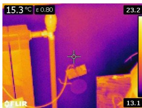
Figura 4.2 – Termograma interior da faixa constituída por uma parede de betão revestida com pedra calcária (junto a um radiador que se encontrava desligado)
