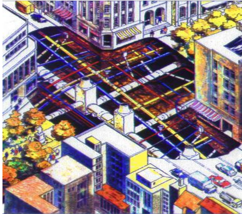
Figura 1.1 – Interferências da construção a céu aberto com infraestruturas existentes (Almeida e Sousa, 2005).
