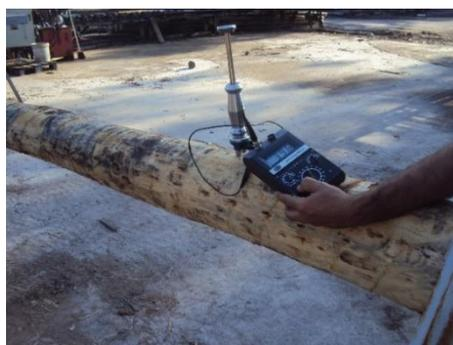
Figura 3.28 – Avaliação do teor de água recorrendo ao humidímetro
