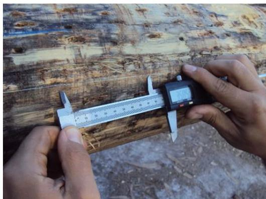
Figura 3.7 – Pormenor da medição da inclinação das fibras numa zona próxima da rotura
