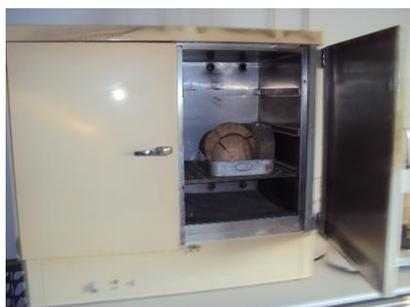
Figura 3.25 – Processo de secagem das rodela próximas da zona de rotura (Postes Novos)
