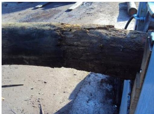
Figura 4.1 – Pormenor da deterioração do poste usado junto à linha terra
