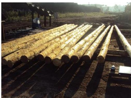
Figura 3.11 - Metodologia do ensaio de vibração longitudinal com utilização do MTG
