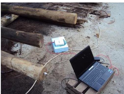
Figura 3.8 – Metodologia do ensaio de vibração longitudinal com utilização do acelerómetro piezoelétrico
