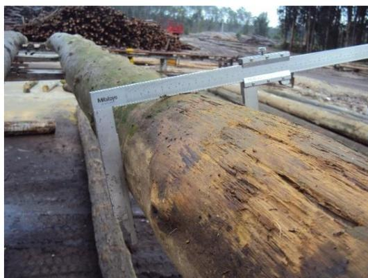
Figura 3.3 – Exemplo ilustrativo da medição de diâmetros através de um paquímetro
