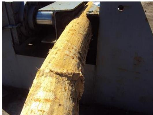
Figura 3.21 – Pormenor de roturas provocadas por compressão
