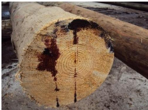
Figura 4.5 – Verificação da eficácia do tratamento aplicado ao poste
