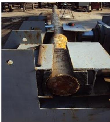
Figura 3.13 – Pormenor do encastramento dos postes nos ensaios do módulo de elasticidade estático e da resistência à flexão
