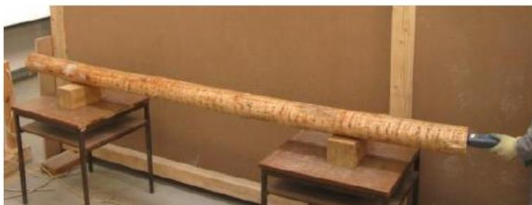
Figura 2.2 – Equipamento de vibração longitudinal, Timber Grader MTG, e sistema de apoio dos toros (Morgado, 2012)
