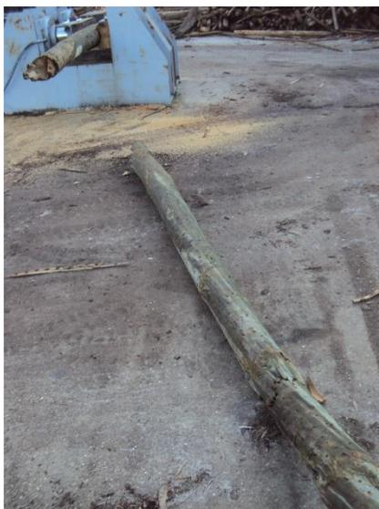
Figura 3.22 – Pormenor de dupla rotura verificada num dos postes usados
