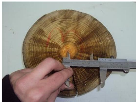
Figura 3.5 – Seção transversal de um poste e respetivos anéis de crescimento
