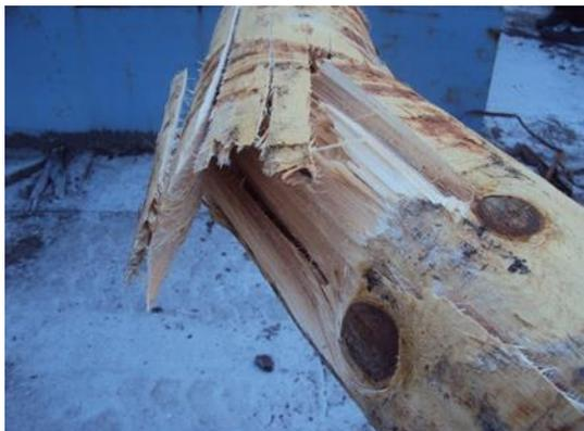
Figura 3.20 – Pormenor de roturas provocadas por tração
