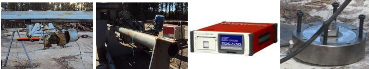
Figura 3.15 – Material de ensaio (esquerda para a direita): defletómetro TML SDP-200D; defletómetro de fio TML DP-1000E; Data Logger TDS-530 (<http://tml.jp>); célula de carga VETEK de 10 tf
