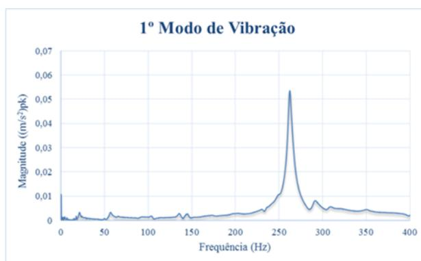
Figura 3.10 – Frequência do 1º modo de vibração através do acelerómetro piezoelétrico
