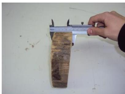
Figura 3.29 – Medição do diâmetro e altura das rodela
