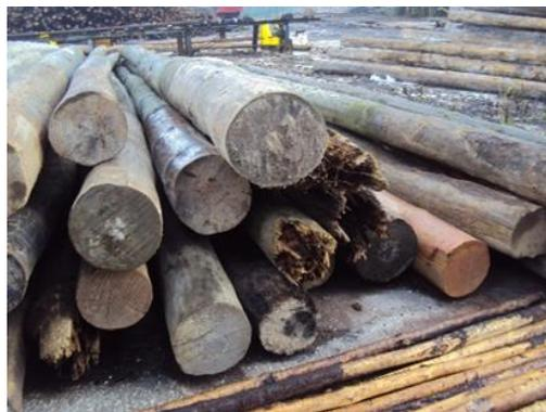
Figura 4.2 – Deterioração dos postes usados disponíveis
