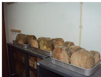
Figura 3.26 – Processo de secagem das rodela próximas da zona de rotura (Postes Usados)
