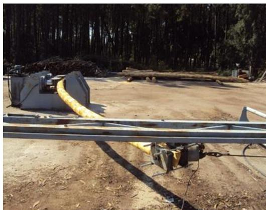
Figura 3.14 – Aplicação da carga durante o ensaio de resistência à flexão
