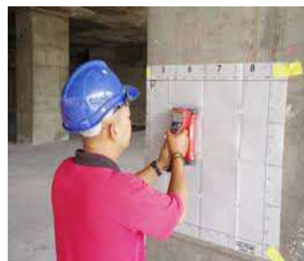
Figura 18: Plano de prospeção das armaduras
