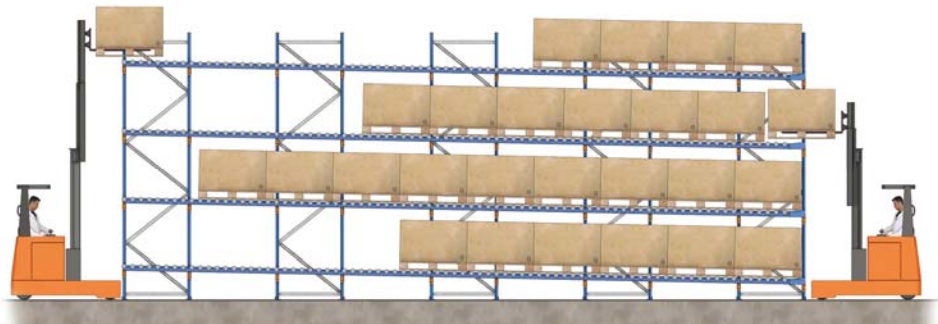
Fig 5.5b. – Armazenamento em Racks Múltiplos – Sistema “Flow – Trough” em palete (Mecalux)
