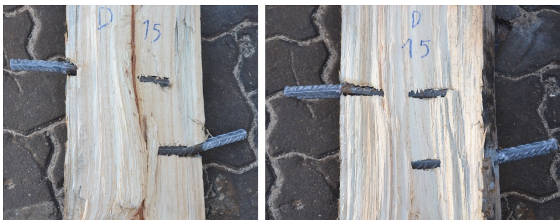
Figura 4.7 - Deformação nos ligadores da série CP90 (provete CP90_15).
