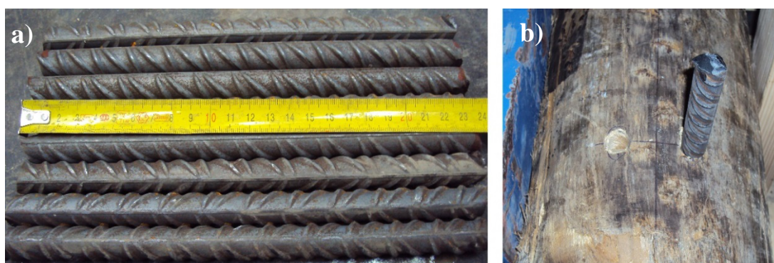
Figura 3.4 - a) Pormenor do comprimento final dos ligadores. b) Pormenor do ligador cravado e da pré-furação na peça de madeira.
