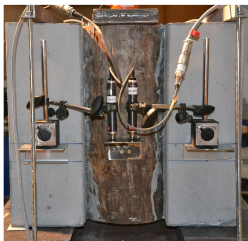
Figura 4.3 - Provete CP90_2 com confinamento no betão.
