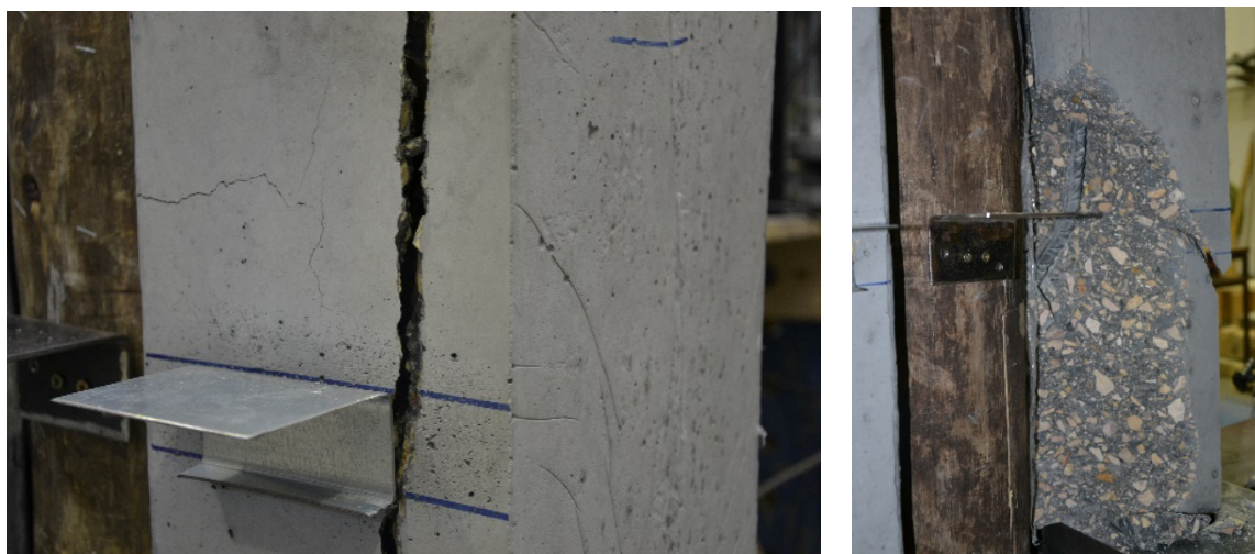
Figura 4.10 - Rotura do provete CI45_10 por splitting no betão.
