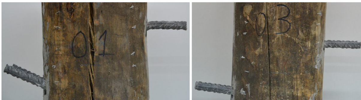
Figura 4.6 – Deformação nos ligadores. Figura do lado esquerdo corresponde ao provete CP90_1, e a figurado lado direito corresponde ao provete CP90_3.
