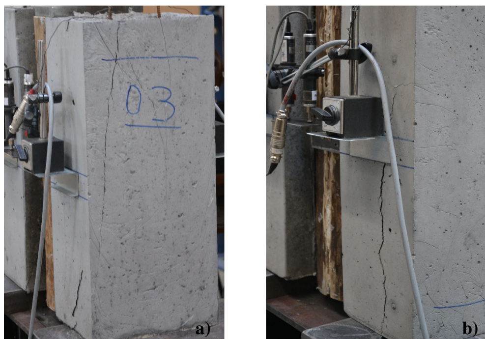
Figura 4.11 - Fissuração observada no betão, antes da rotura total do provete CI45_3: a) plano superior de ligadores; b) plano inferior de ligadores.
