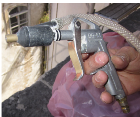
Figura 7.18: Ponteira utilizada na limpeza por micro abrasão.
