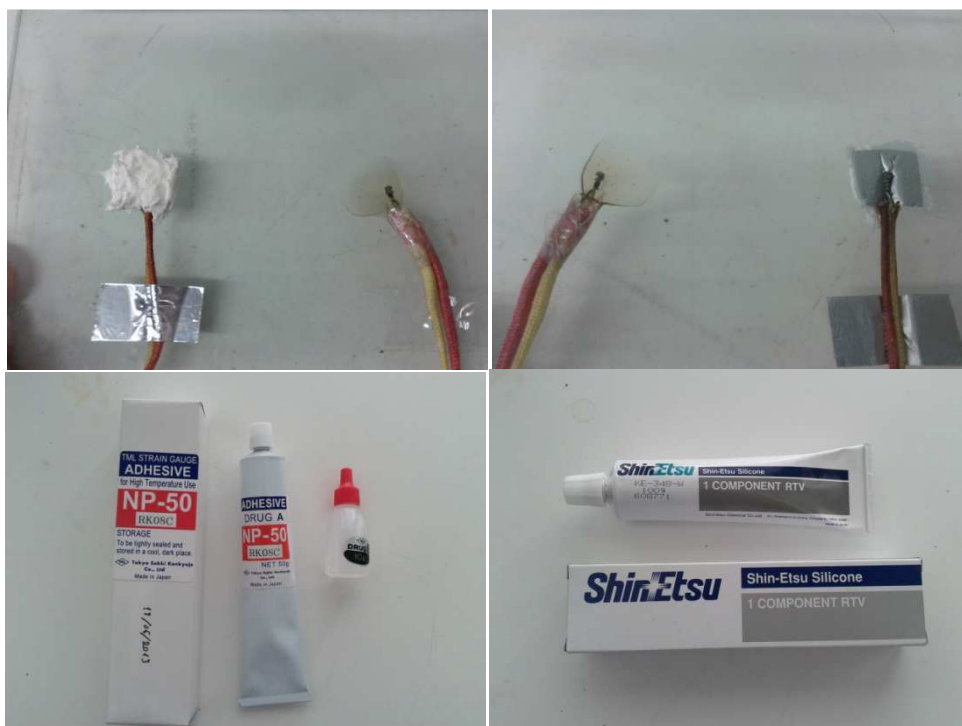
Figura 3.26 - Métodos de colagem dos termopares ao vidro e componentes.
