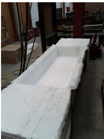
Figura 3.8 - Caixa inferior da câmara térmica.
