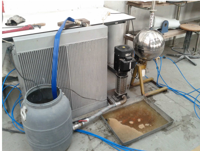
Figura 3.23 - Bomba e sistema de refrigeração a ventoinha.
