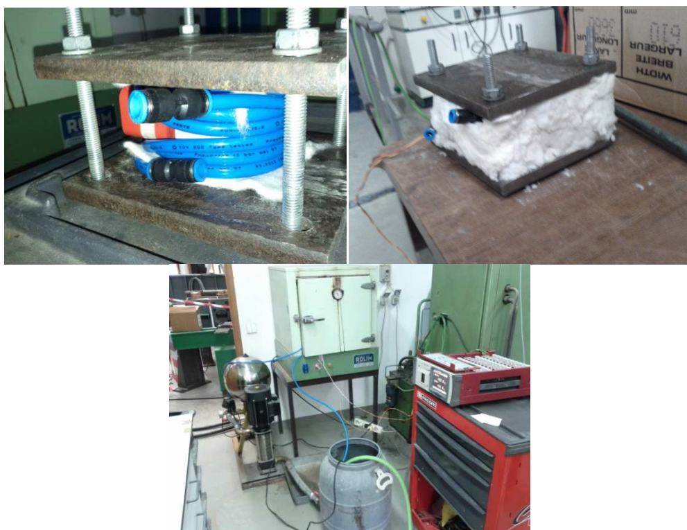
Figura 3.19 - Preparação e Sistema de bombeamento de água para a célula de carga.
