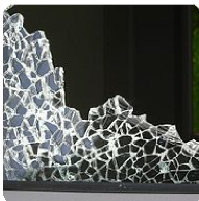
Figura 2.5 – Padrão de fragmentação do vidro temperado (retirado de (Vicar@)).
