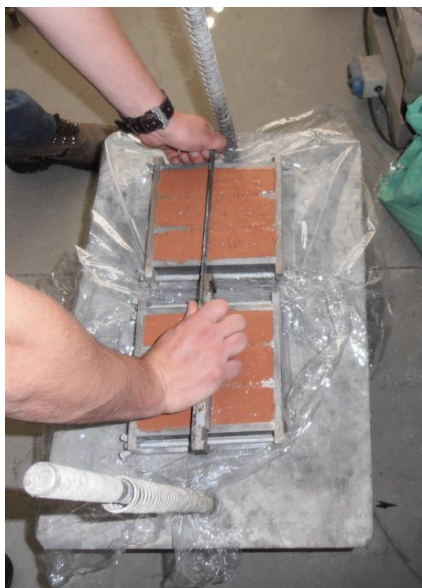
Figura 3. 7 - Vibração das misturas nos moldes.
