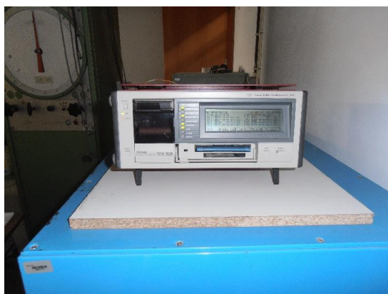
Figura 3. 8 - Data logger usado para o registo da temperatura.
