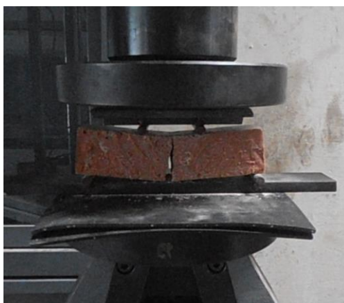
Figura 4. 1 – Provetes dos ensaios de tração. Provetes referência de metacaulino castanho.
