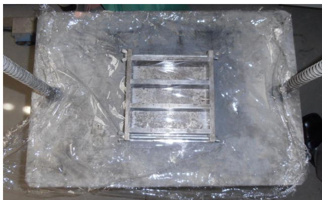
Figura 3. 5 - Preparação dos moldes dos provetes.
