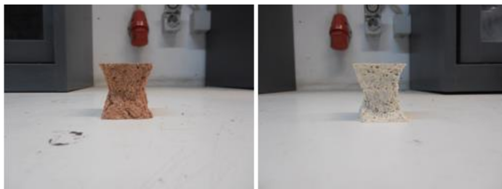
Figura 4. 3 – Modos de rotura atingidos pelos provetes após o ensaio de rotura à compressão.
