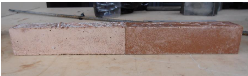
Figura 4. 5 – Aspeto dos provetes realizados a diferentes temperaturas de cura.
