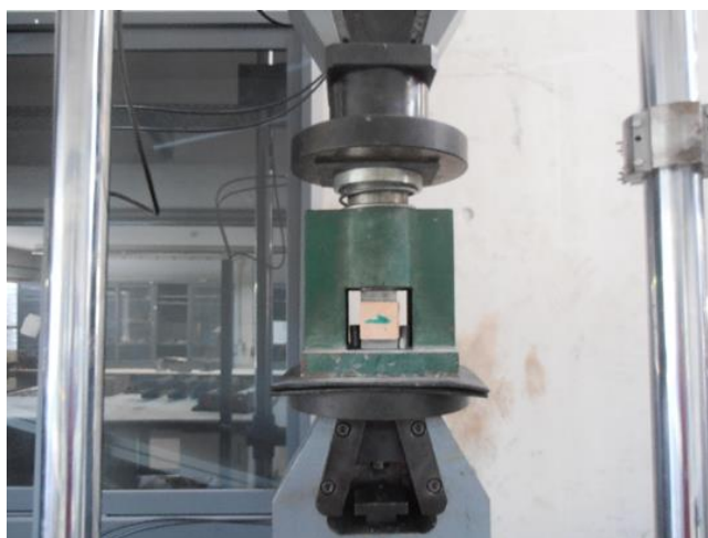
Figura 3. 11 - Ensaio de rotura à compressão
