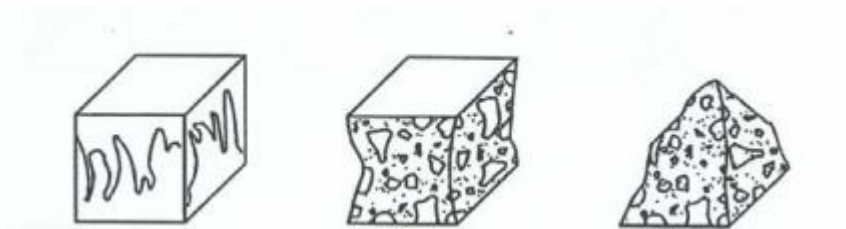
Figura 3. 12 - Modos de rotura de compressão satisfatórios segundo a norma NP EN 12390-3.
