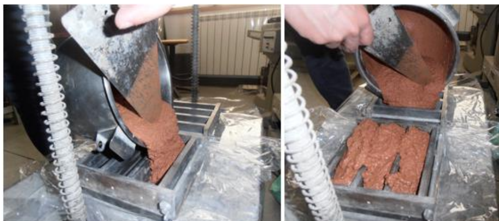
Figura 3. 6 - Colocação da mistura nos moldes.
