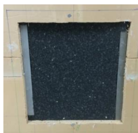
Figura 5.13 - Painel sandwich de pedra e poliuretano flexível com pedra lateral (imagem obtida antes da aplicação da placa de pedra)
