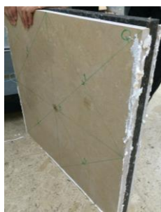
Figura 5.12 – Painel sandwich de pedra e poliuretano flexível
