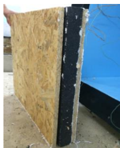
Figura 5.3 – Painel sandwich de OSB e poliuretano flexível
