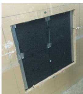
Figura 5.4 – Painel sandwich de OSB e poliuretano flexível com chapa lateral (imagem obtida antes da aplicação da placa de OSB)
