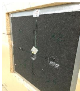
Figura 5.11 – Pannel sandwich de OSB e poliuretano flexível com chapa na sua envolvente (imagem obtida antes da aplicação da placa de OSB)
