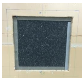
Figura 5.14 - Painel sandwich de pedra e poliuretano flexível com pedra na sua envolvente (imagem obtida antes da aplicação da placa de pedra)
