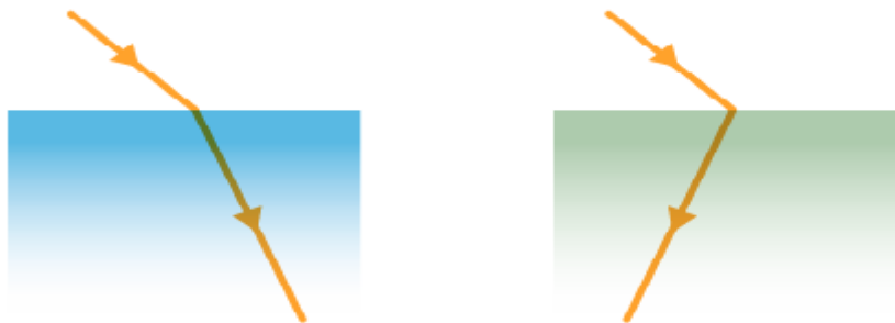
Figura 2.1 – Índice de refração positivo (esquerda) e negativo (direita)
