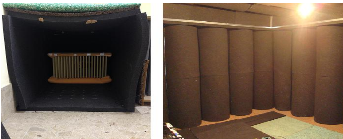
Figura 5.3 – À esquerda “túnel anecoico” e à direita câmara semi-aneecóica
