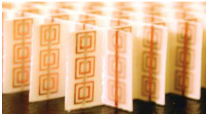
Figura 2.2 – Metamaterial formado por anéis de cobre e fio metálico (Smith et al., 2000)
