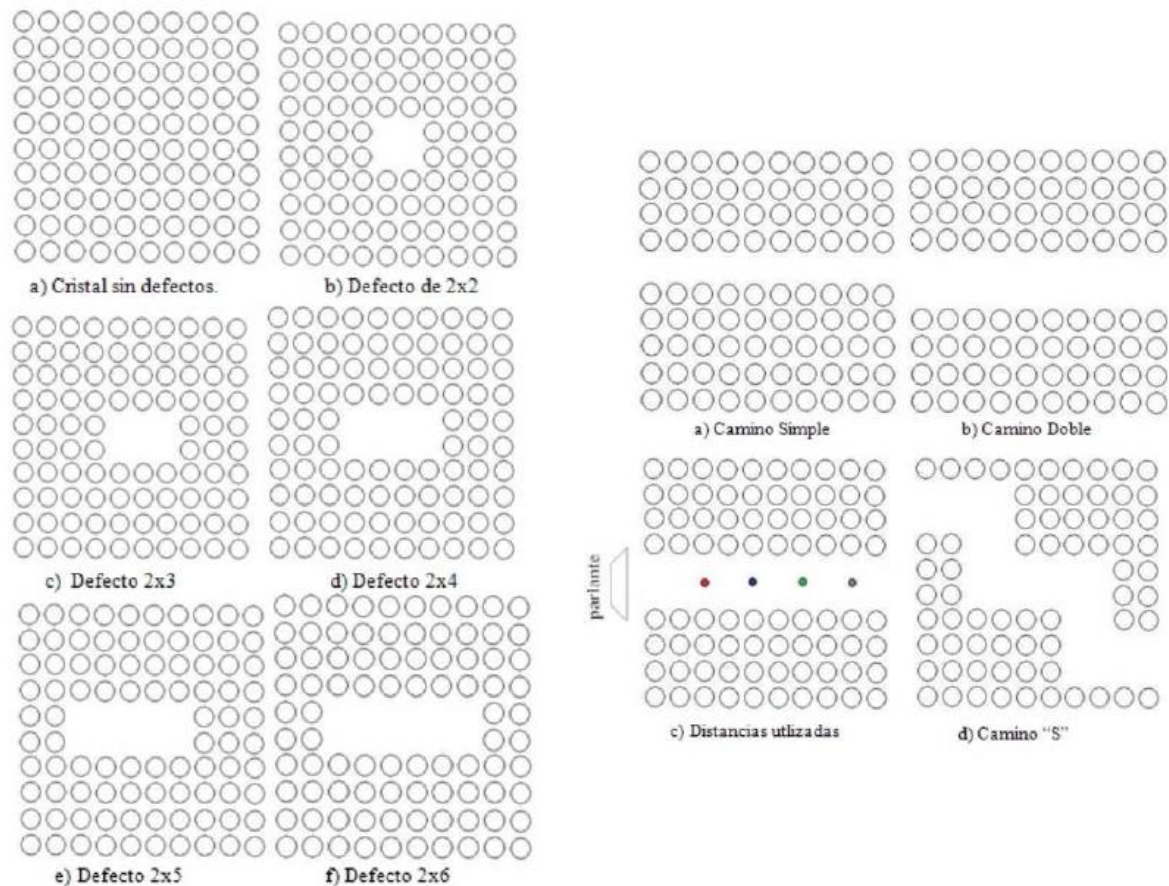
Figura 4.4 – Diferentes configurações com defeitos e caminhos de onda (Babino et al., s.d.)
