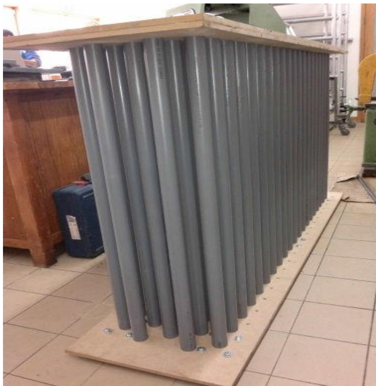
Figura 4.11 – Barreira acústica de cristais sónicos (Martins et al., 2013b)
