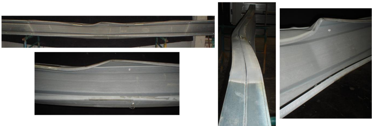
Figura 3.19 - Deformada da viga 2\Sigma com restrição à elongação térmica e à rotação dos apoios ( 2\Sigma_{RR\_03} )
