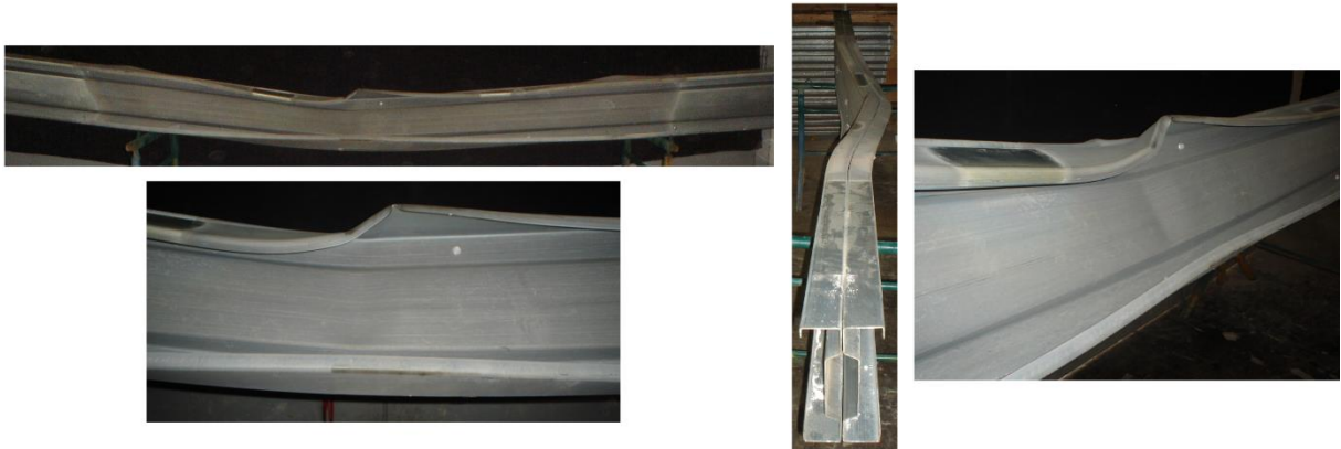
Figura 3.18 - Deformada da viga 2\Sigma com restrição à elongação térmica ( 2\Sigma_{AR\_03} )
