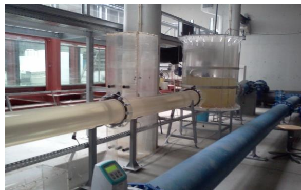
Figura 3.4 – Caixa de visita em acrílico.
