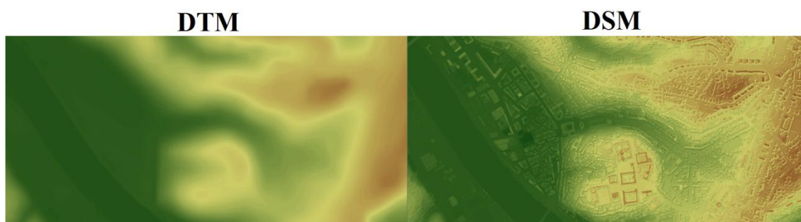
Figura 4.1 – Aspectos apresentados por um DTM e por um DSM
