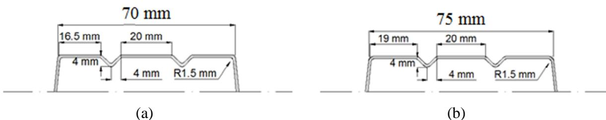
Figura 5.12 – (a) Banzo superior das secções  $\Omega 100$  e  $\Omega 120$ ; (b) Banzo superior das secções  $\Omega 140$  e  $\Omega 160$
