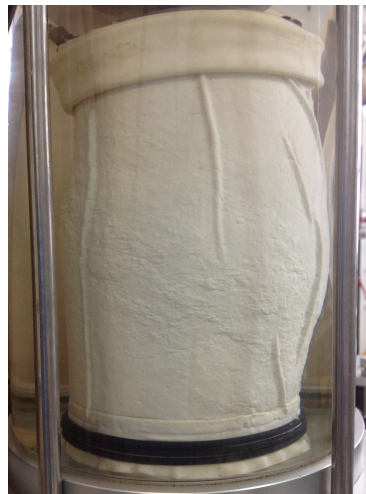
Figura 3.13 – Deformação final da amostra solta consolidada a 200 kPa
