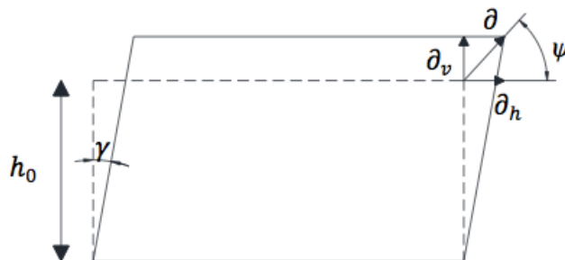
Figura 2.4 – Esquemática do ângulo de dilatância (Matos Fernandes, 2006)
