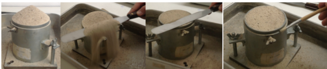
Figura 3.5 – Remoção da areia em excesso
