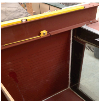
Figura 3.4 – Marcações na parede do tanque para controlo da altura
