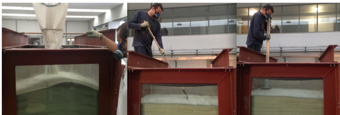
Figura 4.1 – Processo de enchimento/alisamento/compactação da areia ensaiada
