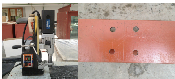
Figura 3.2 – Equipamento de furação e furos efectuados numa das vigas do sistema de reação
