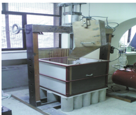
Figura 2.12 – Exemplo de tanque para ensaios de carga em placa em modelos à escala reduzida (Tafreshi, Mahrjardi e Ahmadi (2010))
