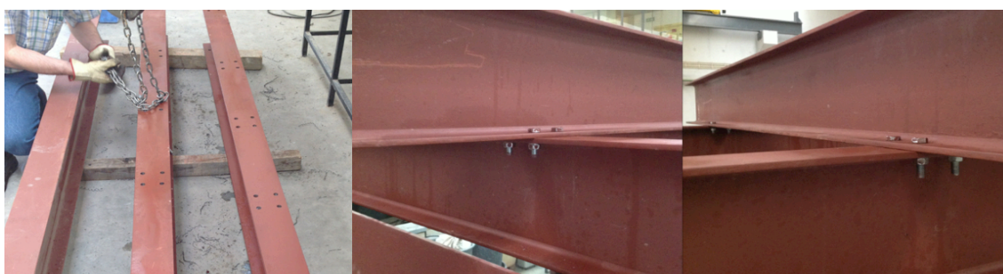
Figura 3.11 – Pormenores dos furos/ligação do sistema de reação
