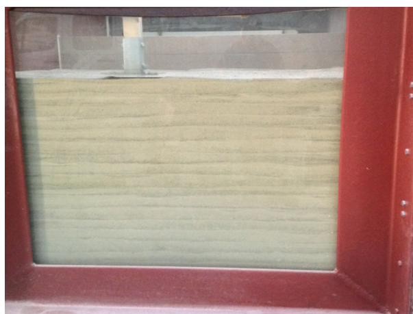
Figura 4.2 – Tanque de ensaios com o enchimento completo
