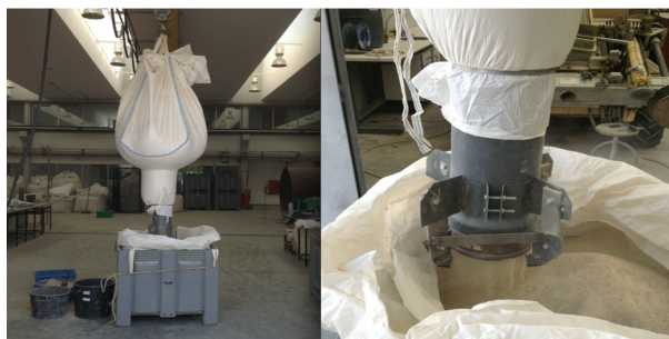
Figura 3.5 – Sistema de peneiração adaptado para os sacos de grande dimensão
