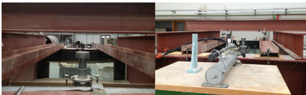
Figura 4.3 – Viga de reação, placa com veio extensível e macaco hidráulico na sua posição em um dos ensaios
