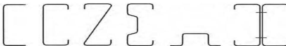
Figura 3.4 – Secções transversais de perfis estruturais de aço enformados a frio (LSK, 2005)
