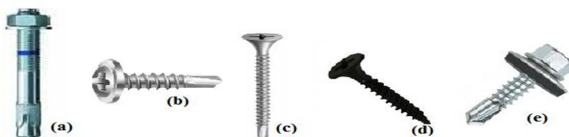
Figura 4.3 – Diversidade de parafusos usados em LSF para: (a) ancoragem; (b) perfis metálicos; (c) placas OSB; (d) placas de gesso; (e) vigas metálicas.
