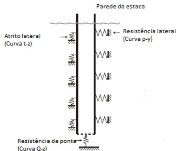
Figura 6.2- Modelo de molas para a interação estaca-solo (Jan van der Tempel, 2006 )
