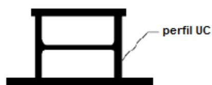
A secção transversal da viga é constituída por um perfil laminado tipo *Universal Column* (UC), posicionado com a alma na direção horizontal e os banzos na direção vertical e duas placas de aço soldadas às abas do perfil UC.
