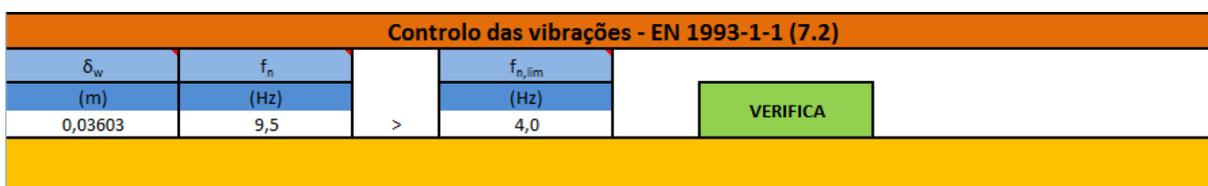
Figura 46 - Validação do programa para a verificação das vibrações - exemplo 1
