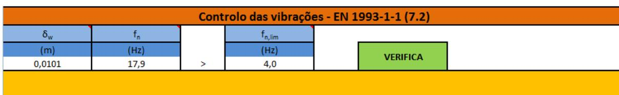
Figura 56 - Validação do programa para a verificação das vibrações - exemplo 2
