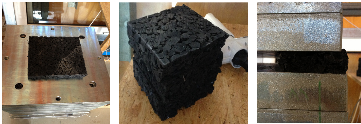
Figura 3.3 - Amostra de aglomerado de poliuretano reciclado ensaiada com diferentes dimensões.
